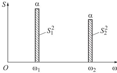
Рис. 2. Стилизованные спектральные плотности в виде двух дельта-функций
