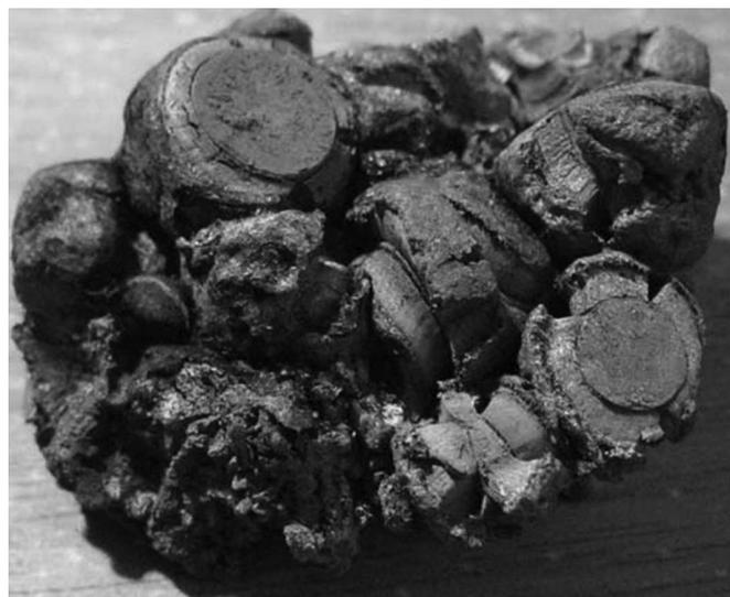
Рис. 1. Спек переработанного твердого сплава
