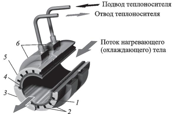
Рис. 1. Рекуперативный теплообменный аппарат с МКТТ:
