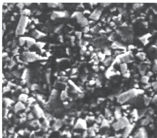
Рис. 1. Микрофотография поверхности изнашивания твердого сплава VK8 (1:5000). Обрабатываемый материал — сталь 45, скорость резания V = 10 м/мин
