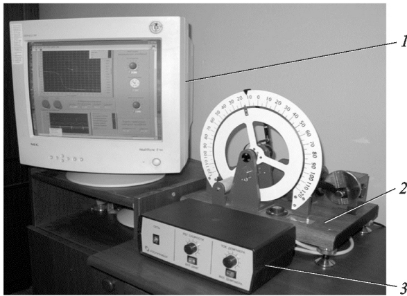
Рис. 1. Общий вид автоматизированного лабораторного комплекса: 1 — монитор; 2 — электромеханическая установка; 3 — блок управления
