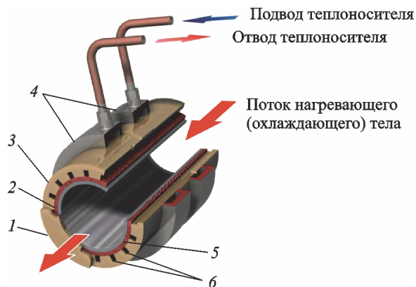
Рис. 1. Схема РТА с МКТТ: 1 — фланец; 2 — вставка из ПСМ; 3 — корпус; 4 — подводящий и отводящий коллекторы; 5 — внутренняя стенка; 6 — подводящие и отводящие каналы
