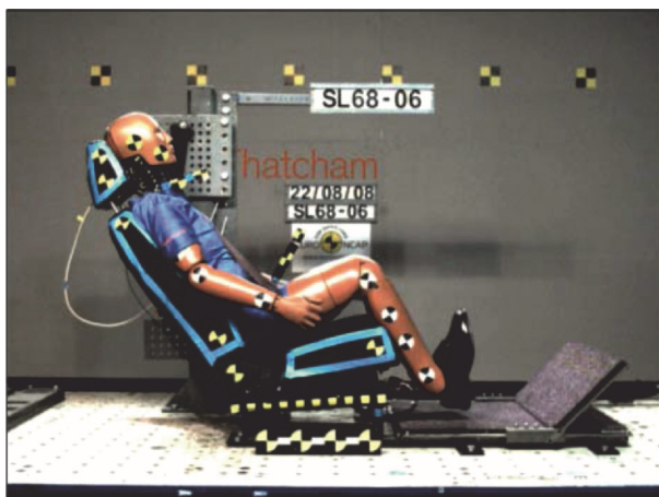
Рис. 2. Испытания автомобильного кресла в соответствии с требованиями Euro NCAP
