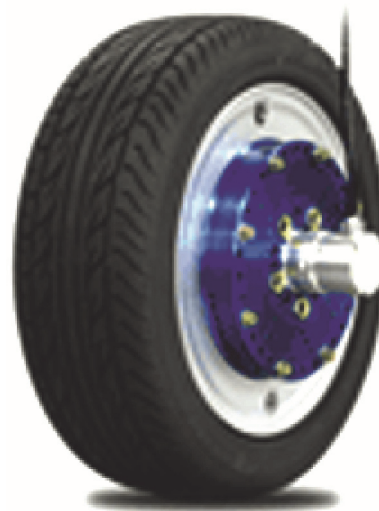
Рис. 4. Шестикомпонентный датчик сил и моментов, действующих на колесо автомобиля
