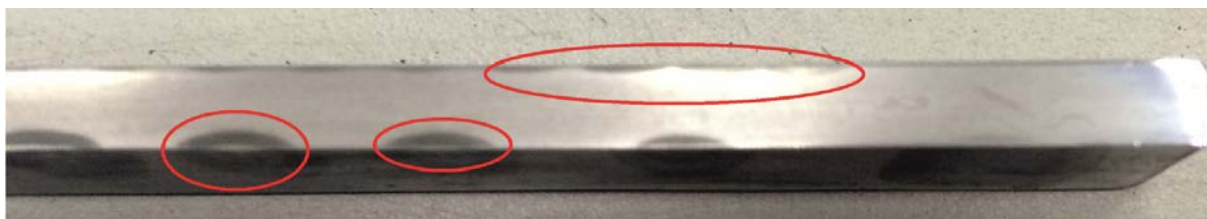
Рис. 5. Торцевая поверхность пластины после травления с видимыми упрочненными слоями
