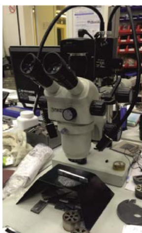
Рис. 7. Измерение глубины термоупрочненного поверхностного слоя ( a , б ) и микротвердости ( в ) при мощности лазерного излучения P = 1\ 050 Вт
