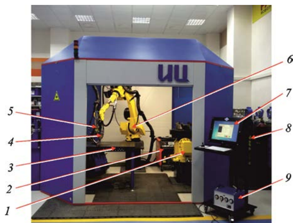
Рис. 1. Лазерный роботизированный комплекс: 1 — двухосевой позиционер; 2 — генератор; 3 — рабочий стол; 4 — датчик слежения; 5 — иттербиевый волоконный лазер ЛС-3; 6 — робот с шестью степенями свободы; 7 — пульт управления; 8 — емкость с технологическим газом; 9 — газовый смеситель
