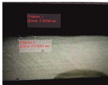
Рис. 7. Измерение глубины термоупрочненного поверхностного слоя ( a , б ) и микротвердости ( в ) при мощности лазерного излучения P = 1\ 050 Вт
