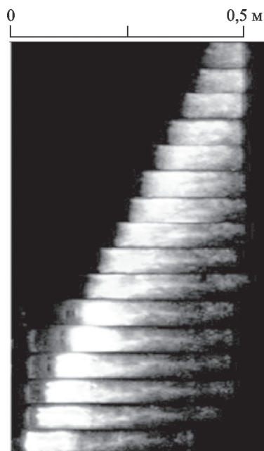
Рис. 3. Пример визуализации структуры детонационной волны (сносящий поток направлен слева направо)
