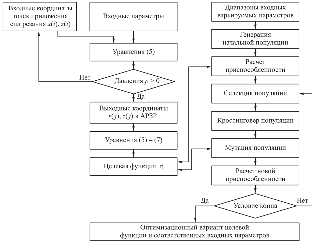
Рис. 4. Концептуальная блок-схема оптимизации методики ГА
