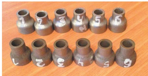
Рис. 2. Образцы, изготовленные по технологии СЛС
