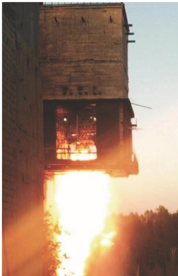
Рис. 7. Запуск двух основных КС двигателя РД107 с ЛЗ на стенде ПАО «Кузнецов» [14]
