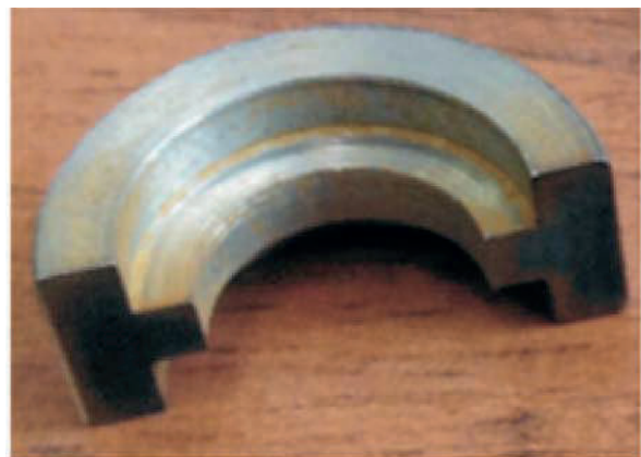
Рис. 3. Схема (а) и внешний вид устройства (б) для центровки образцов
