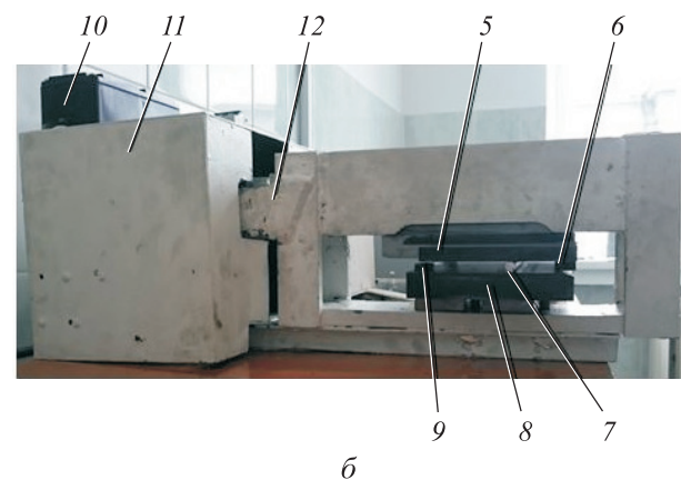
Рис. 1. Кинематическая схема (а) и внешний вид (б) правильно-обкатного станка:
