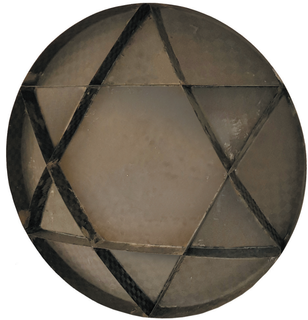
Рис. 1. Оребренная выпуклая поверхность опытной конструкции антенного рефлектора
