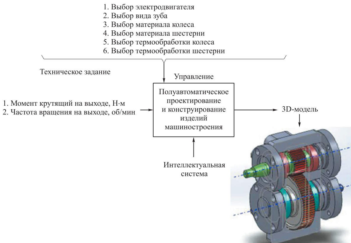
Рис. 10. Функциональная модель ИС полуавтоматического 3D-проектирования цилиндрического редуктора
