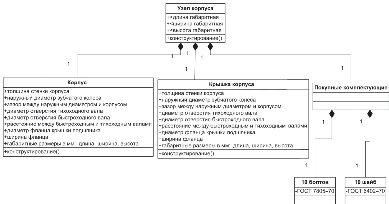
Рис. 5. Диаграмма классов узла корпуса цилиндрических редукторов
