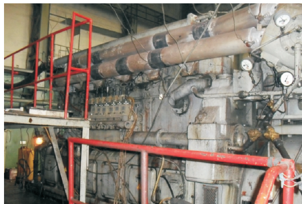
Рис. 4. Общий вид моторного стенда с электроуправляемым ТНВД 4ЭТН.03 системы электронного управления топливоподачей ЭСУВТ.01
