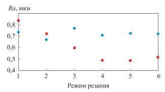
Рис. 3. Зависимость параметра шероховатости поверхности Ra образцов из титанового сплава ОТ4-1 от режима резания при БФ (◆) и  $T\Phi$  (■)
