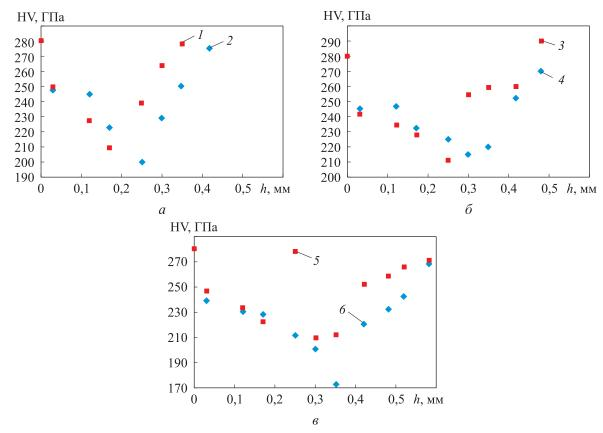
*Рис.* 5. Зависимости микротвердости HV от глубины h приповерхностного слоя образцов из сплава ОТ4-1 при высокоскоростном ТФ в режимах 1, 2 (a), 3, 4 ( $\delta$ ) 5, 6 ( $\epsilon$ )
