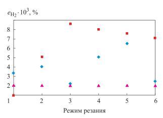
Рис. 4. Зависимость содержания водорода  $e_{\rm H_2}$  в поверхностном слое образцов из сплава ОТ4-1 при БФ (◆) и ТФ (■) от режима резания
