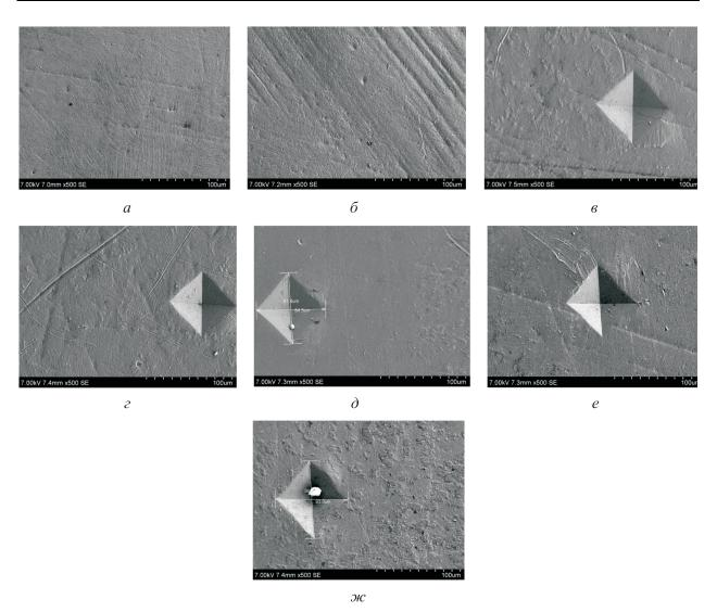
*Рис.* 6. Микроструктуры приповерхностного слоя образцов из сплава ОТ4-1 в исходном состоянии (*a*) и после высокоскоростного ТФ при первом ( $\delta$ – $\epsilon$ ) и третьем ( $\delta$ – $\pi$ ) режимах резания и разной глубине:  $\delta$ ,  $\delta$  — h = 0,03 мкм;  $\epsilon$ ,  $\epsilon$  — h = 0,17 мкм;  $\epsilon$  — h = 0,35 мкм;  $\pi$  — h = 0,42 мкм
