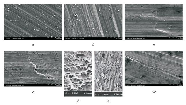
*Рис. 7.* Электронные фрактограммы макрорельефов образцов после различных видов и режимов механической обработки:
