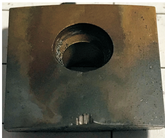
Рис. 4. Вид износа по задней поверхности тангенциальной РП
