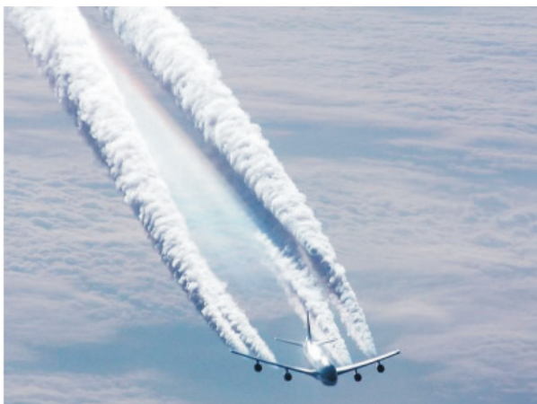
Рис. 1. Фотография вихревого конденсационного следа, образующегося за самолетом
