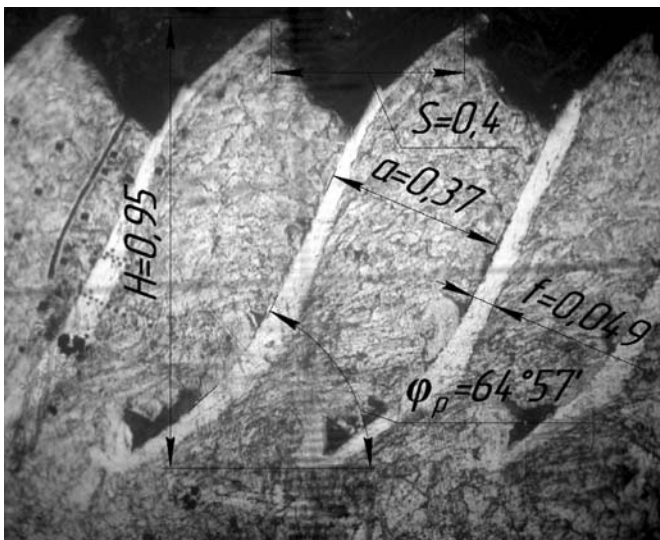
Рис. 8. Регулярный макрорельеф на стали 40X
