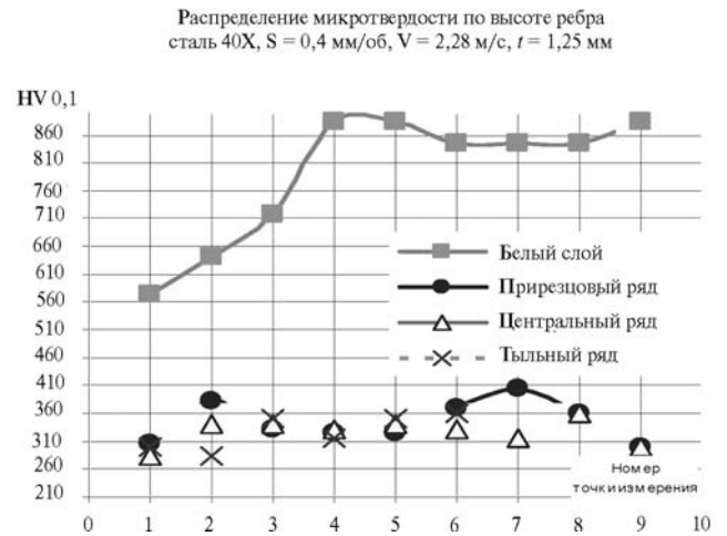
Рис. 10. Распределение микротвердости по высоте ребра на стали 40X
