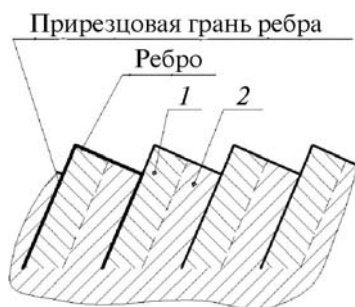
Рис. 3. Макрорельеф с наклонной структурой без зазоров:
