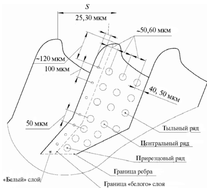
Рис. 9. Схема измерения микротвердости
