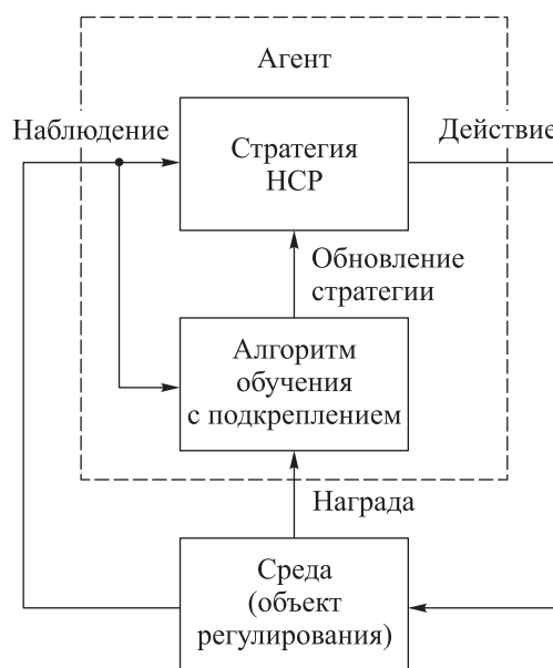
Рис. 2. Схема метода обучения НС с подкреплением
