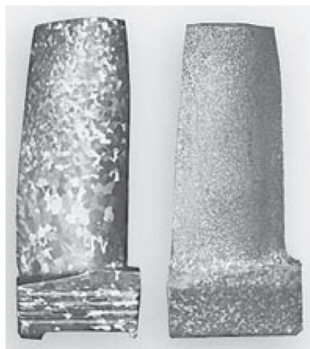
Рис. 1. Внешний вид отливок лопаток при отсутствии (а) и наличии (б) модификатора
