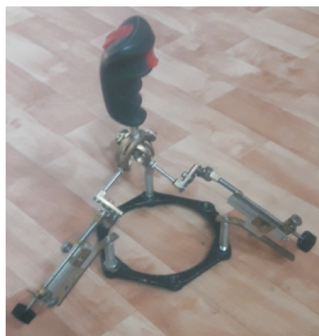
Рис. 4. Схема (а) и внешний вид прототипа (б) шестикоординатного ЗД с кинематической развязкой
