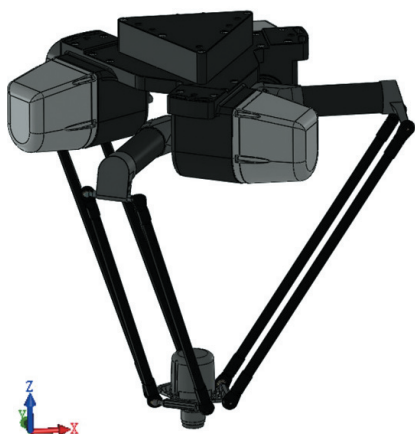
Рис. 2. Упрощенная 3D-модель дельта-робота WSC-600DJ, созданная в среде SolidWorks
