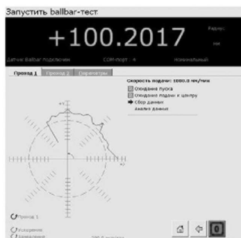
Рис. 8. Основные этапы оценки геометрической точности станков автоматизированной измерительной системой Ballbar фирмы Renishaw:
