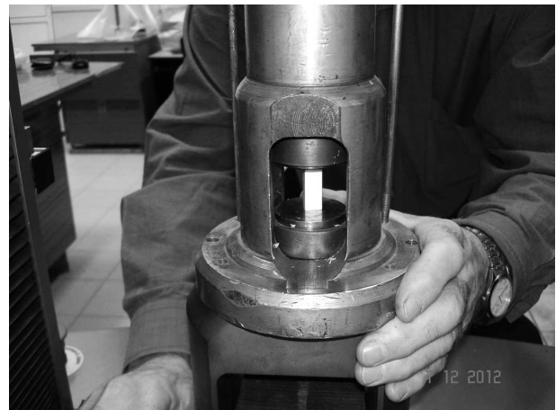
Рис. 1. Установка бруска из фторопласта Ф-4 между рабочими пластинами лабораторной машины сжатия
