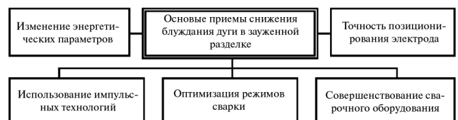
Рис. 6. Основные приемы снижения блуждания дуги в зауженной разделке
