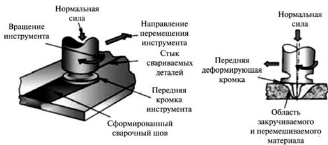
Рис. 1. Схема фрикционной сварки
