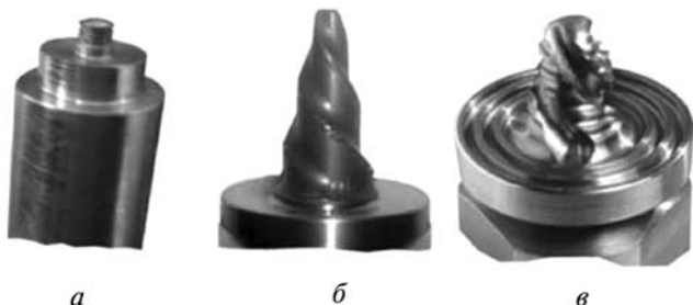
Рис. 2. Рабочие части инструментов, используемых при фрикционной сварке:
