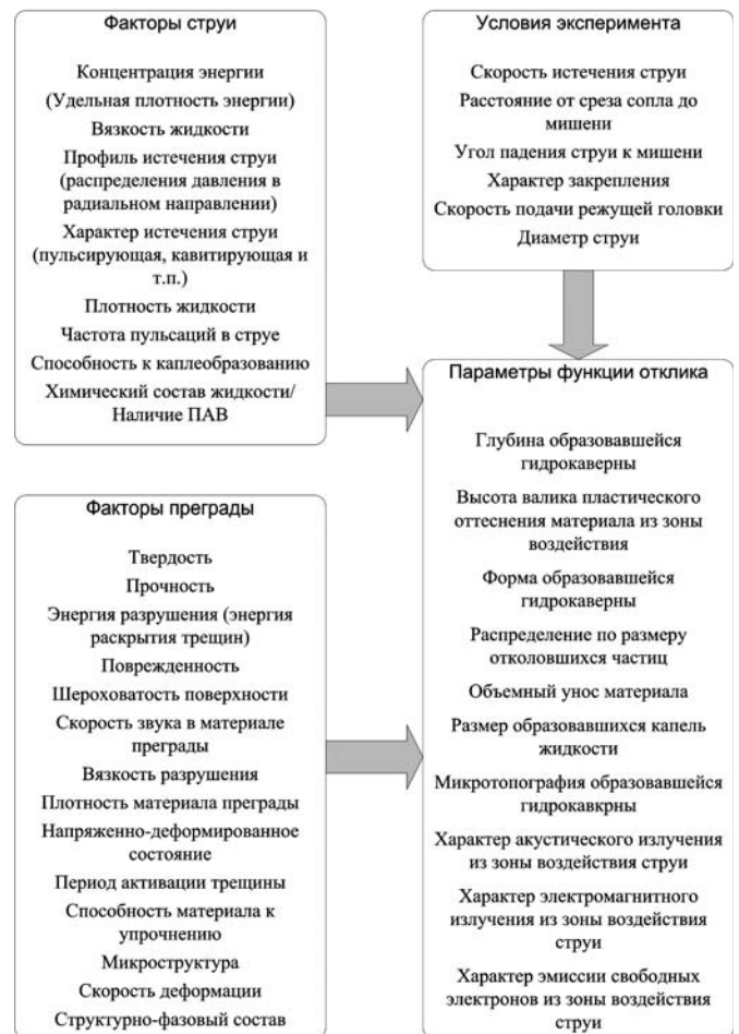
Рис. 4. Обобщенная схема влияния различных параметров на характеристики гидроэрозионного разрушения
