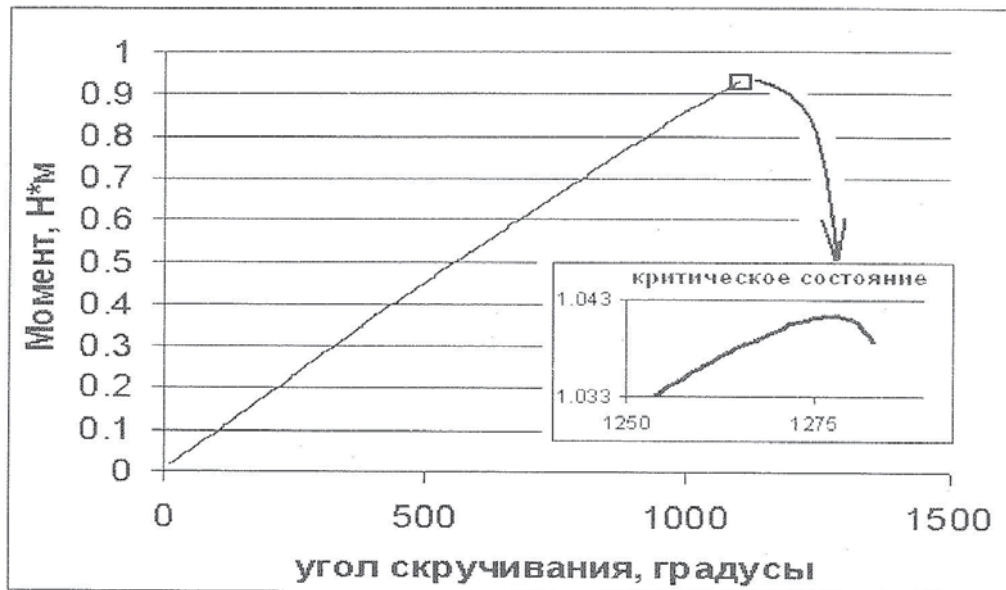
Рис. 5. Упругая характеристика для пружины (с закрепленным в осевом направлении вторым концом) подверженной скручиванию.
