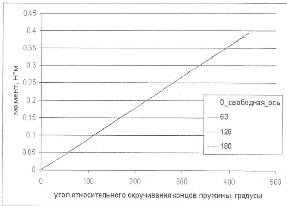
Рис.2. Упругие характеристики пружин с различным углом изгиба оси в дугу окружности.
