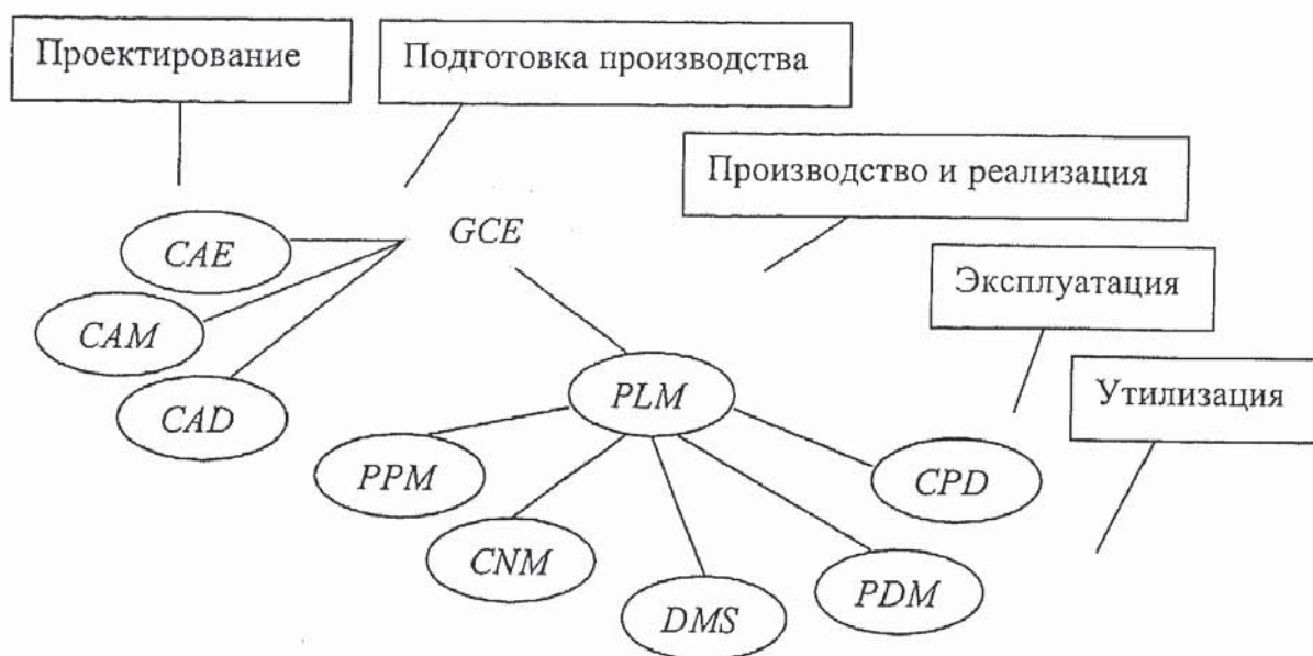
Рис. 1. Этапы жизненного цикла промышленных изделий и системы их автоматизации: GCE — Global Collaborative Environment (глобальное коллективное окружение); CAE — Computer Aided Engineering (автоматизированные расчеты и анализ); CAD — Computer Aided Design (автоматизированное проектирование); CAM — Computer Aided Manufacturing (автоматизированная технологическая подготовка производства); PDM — Product Data Management (управление проектными данными); CPD — Collaborative Product Design (коллективная разработка); DMS — Direct Materials Sourcing (прямое управление поставками материалов); CNM — Customer Needs Management (управление требованиями заказчиков); PPM — Product Portfolio Management (управление спектром продукции)
