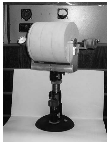
Рис. 5. Двухопорный ВТСП-подвес с теплоизоляцией, закрепленный на стойке для проведения силовых измерений
