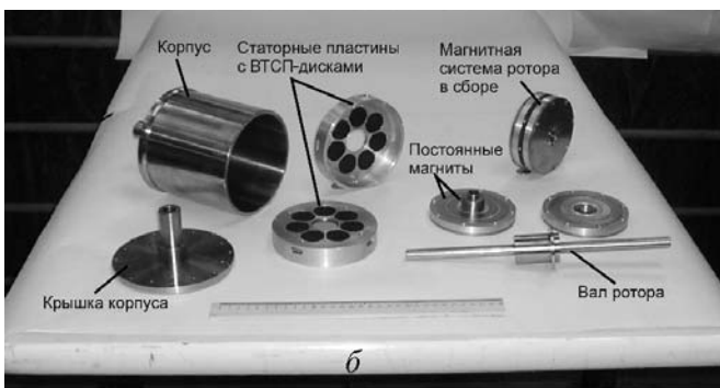
Рис. 3. Фотографии магнитного подвеса ротора гиromотора: а — в сборе; б — элементы подвеса
