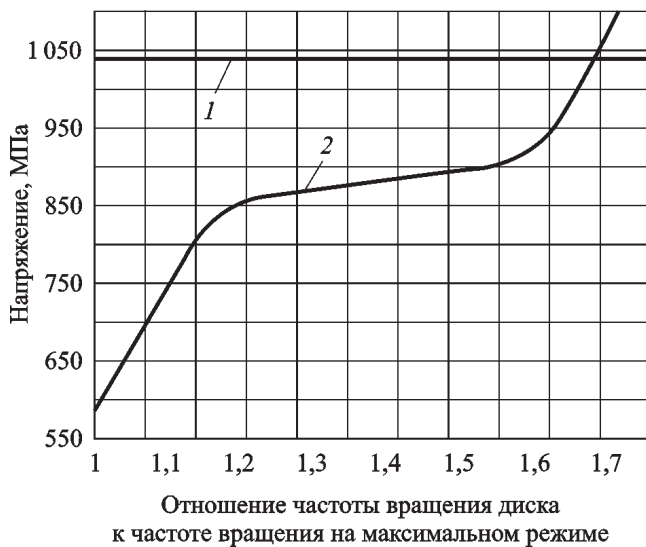
Рис. 10. Определение несущей способности зоны 2 (хвостовик) в модели металлический диск/металлическая лопатка по критерию (2):
