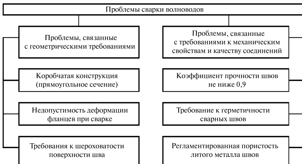
Рис. 8. Основные проблемы, существующие при сварке волноводов
