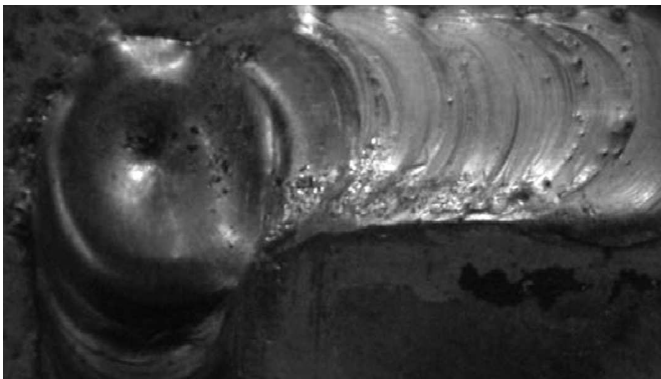
Рис. 5. Усадочная раковина и мелкие поверхностные поры в сварном шве
