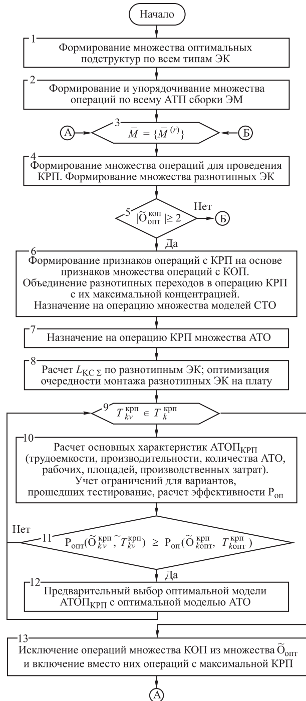
Рис. 1. Фрагмент алгоритма проектирования оптимальных технологических операций сборки изделий ЭМ из разнотипных компонентов в многономенклатурном производстве
