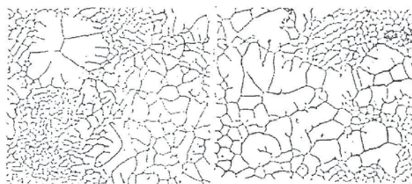
Рис. 7. Дендритная структура гранул сплава Д 16 при ступенчатом охлаждении, \times 340
