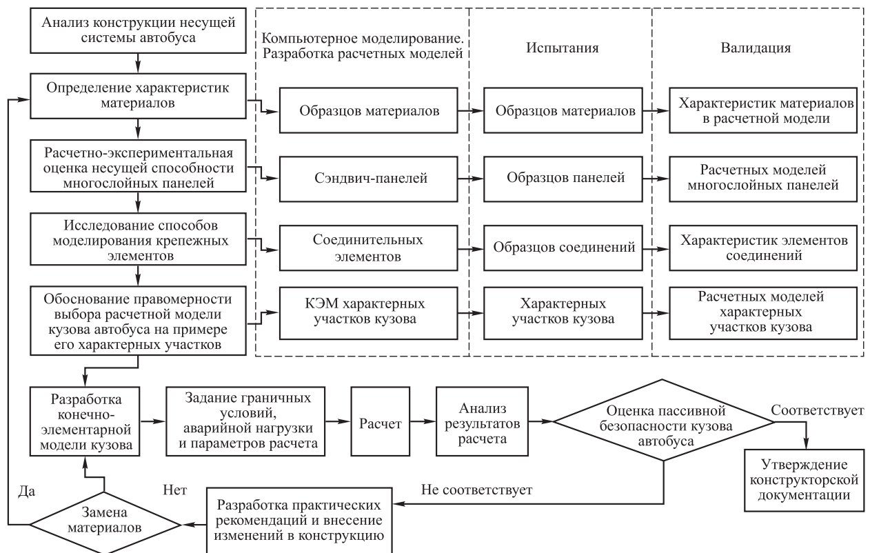
Рис. 1. Блок-схема методики расчетно-экспериментальной оценки пассивной безопасности кузовов из многослойных панелей автобусов: КЭМ — конечно-элементарная модель
