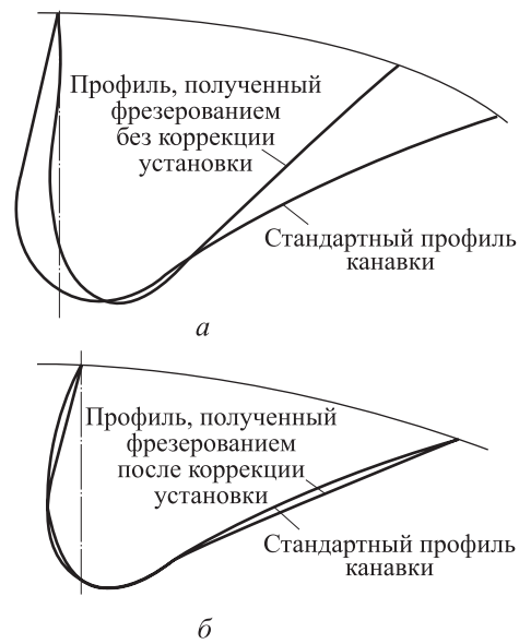
Рис. 4. Профили нормального сечения стружечных канавок, обработанных угловой фрезой:
