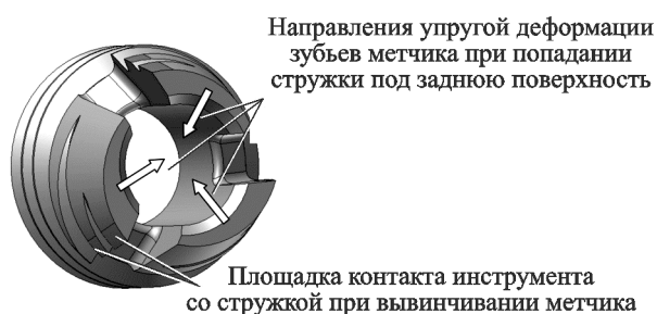
Рис. 1. Конструкция режущей части метчика с внутренним размещением стружки
