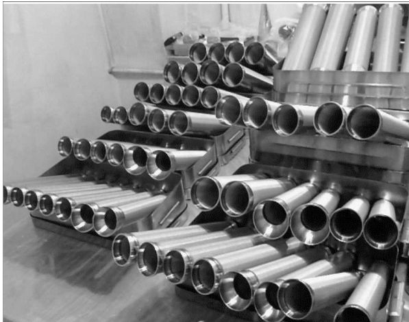
Рис. 1. Комплект фазоразделителей из КПСМ для КЗУ ДТБ разгонного блока «Бриз-М» (подготовка к ПСИ и отправке потребителю)
