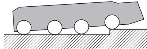
Рис. 5. Преодоление КМ эскарпа высотой 0,6 м
