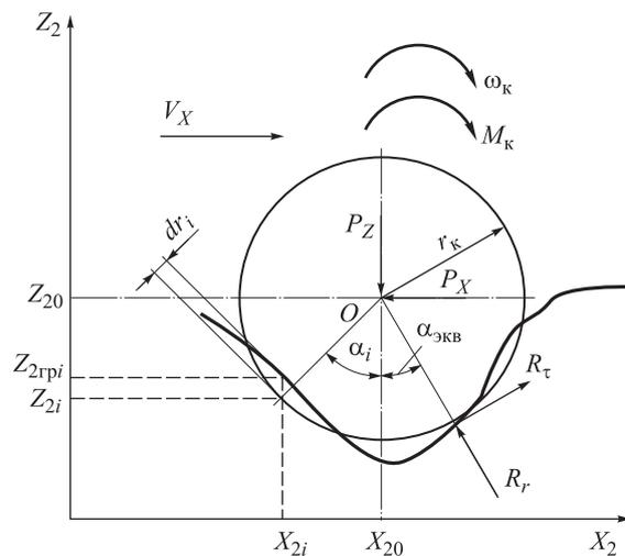
Рис. 3. Расчетная схема качения колеса по неровностям опорного основания
