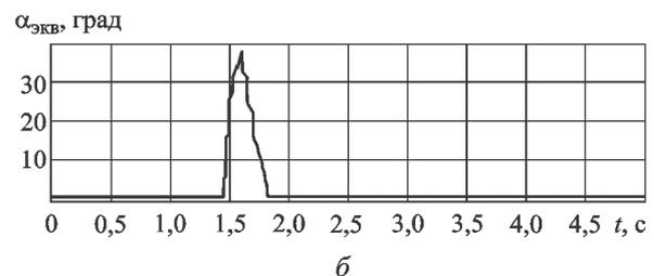
Рис. 6. Зависимости угла  $\alpha_{эКВ}$  от времени  $t$  для переднего левого колеса КМ при движении по неровностям грунтовой дороги (а) и при преодолении эскарпа (б)
