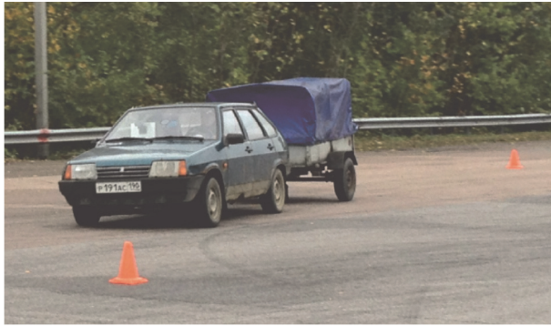
Рис. 5. Проведение экспериментального заезда «переставка S_n = 20 м»
