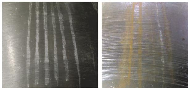
Рис. 4. Термоиндикаторные линии до (а) и после (б) нагрева заготовки
