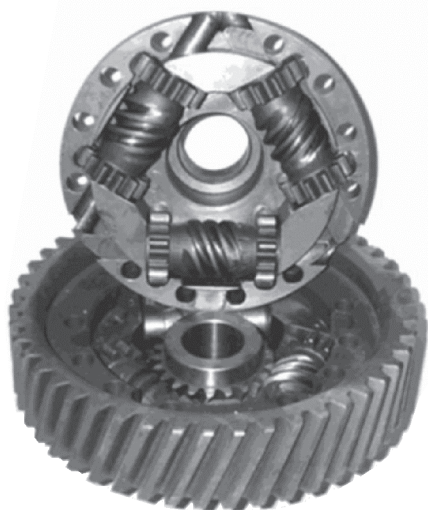
Рис. 1. Самоблокирующийся дифференциал для автомобиля «Урал» с червячно-винтовыми передачами
