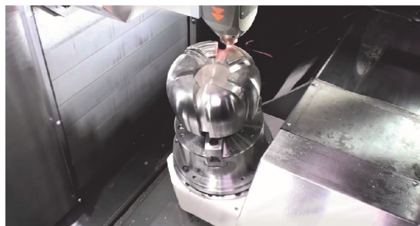
Рис. 2. Наплавка на поверхность тестовой детали
