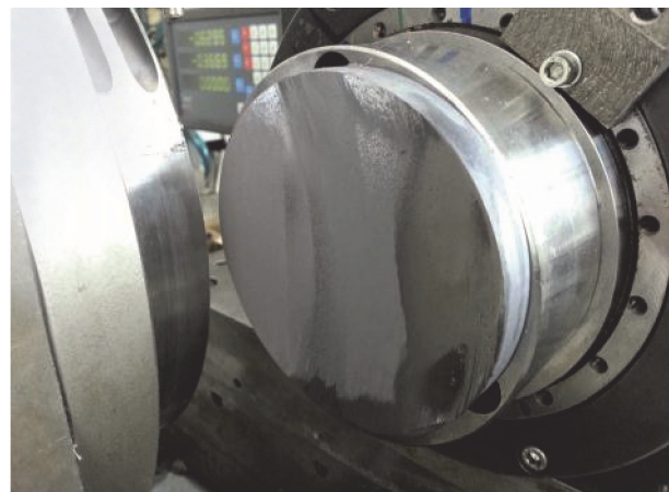
Рис. 10. Обработанная поверхность кремния с остатками СОЖ и стружки
