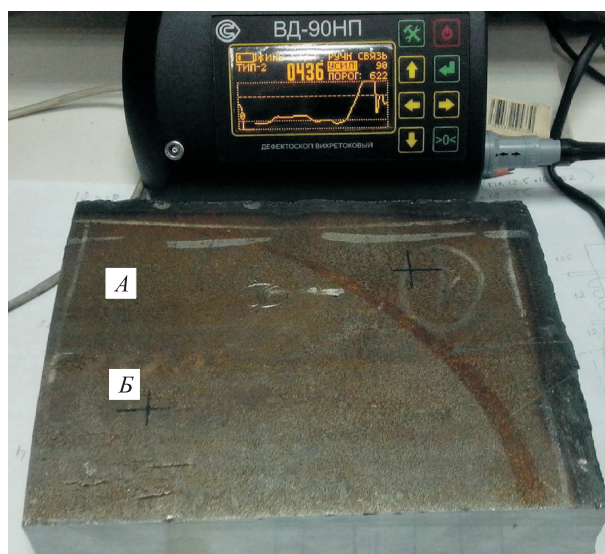
Рис. 6. Показания дефектоскопа ВД-90НП по линии АВ
