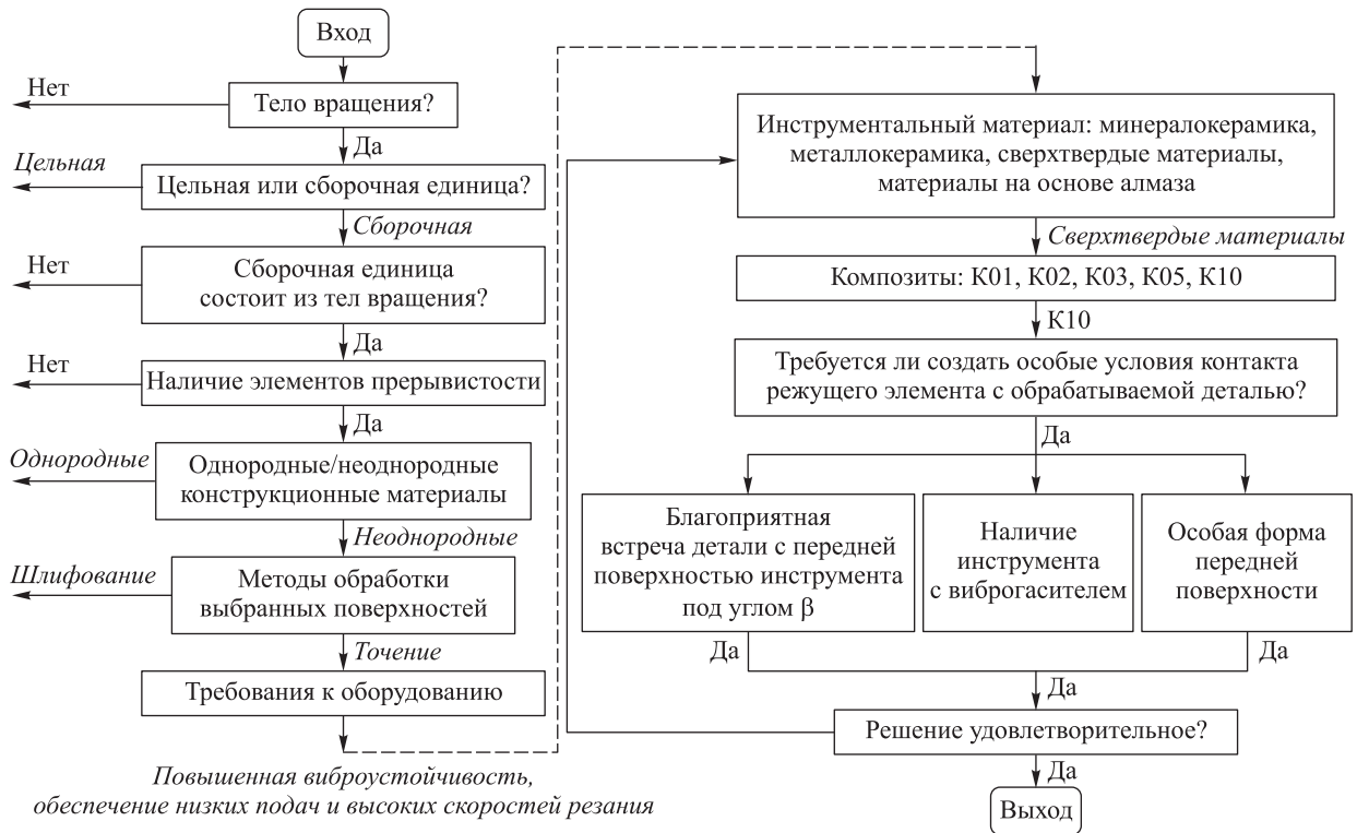
Рис. 8. Схема принятия решений для устранения проблем, возникающих в ходе обработки точением прерывистых поверхностей деталей
